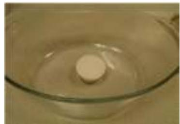
3. Vierta 5 ml  $\pm$  1 ml de formula disolvente en el algodón, evitando que la superficie del tapón sin tratamiento entre en contacto con el disolvente.
