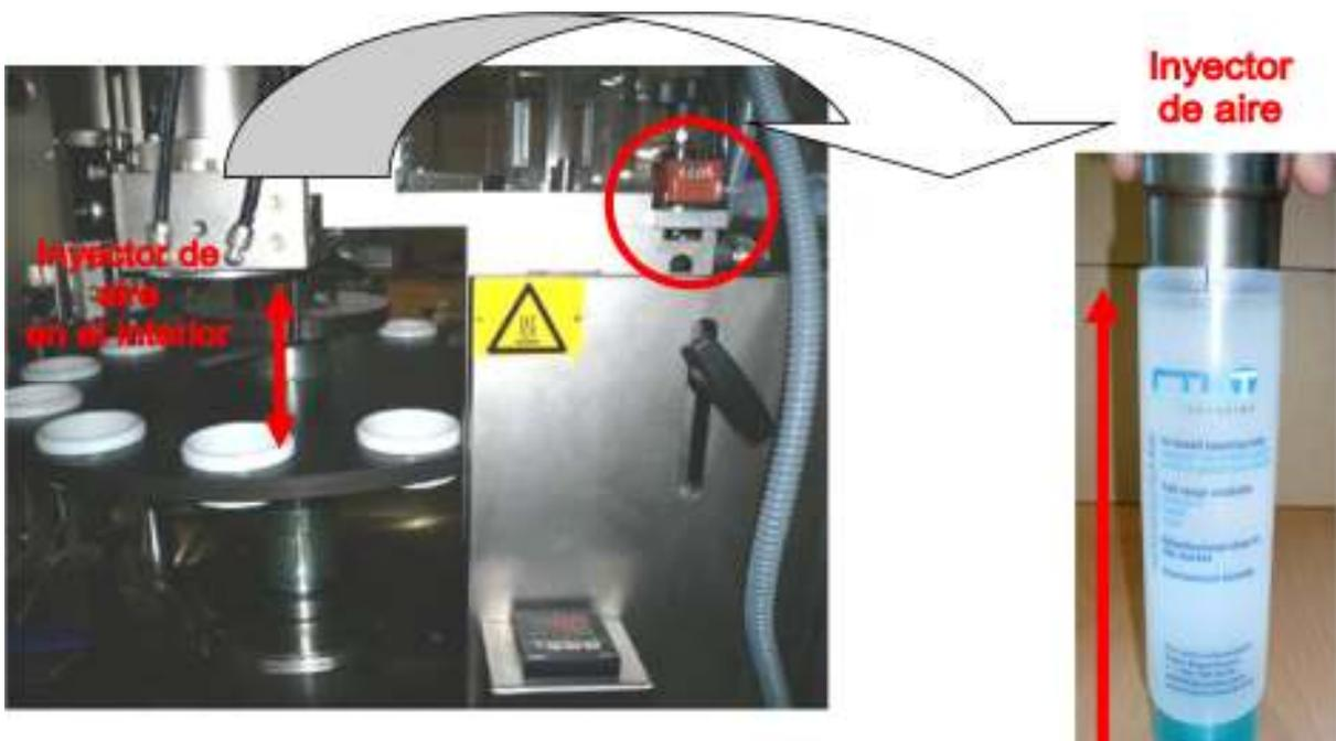
2. Posteriormente, se hace fluir aire hacia el interior de las muestras a una presión de 1.5 bar ( $\pm 0.05$  bar) durante 10 segundos ( $\pm 5$  seg).
