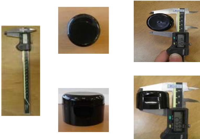
Para verificar la conformidad de la altura de cierre del tapón (AC):
