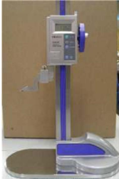
2. Poner a “0” el medidor, apoyando la pestaña sobre la superficie donde se va a apoyar el tubo.
