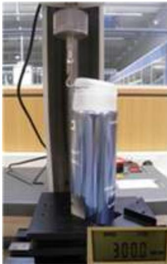
4. La apertura se lleva a cabo tirando en el punto medio del resalte del uñero según un eje paralelo al eje del mandrino-soporte, a una velocidad de 300 mm/min.
