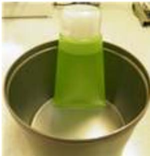
3. La otra mitad de los tubos se rellena de solución hasta la mitad y se suelda según el método NG 319.
