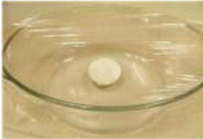
4. Cubra el cristalizador con una capa de película (Parafilm) protectora. Asegúrese de que la superficie esta cubierta para evitar la evaporación.
